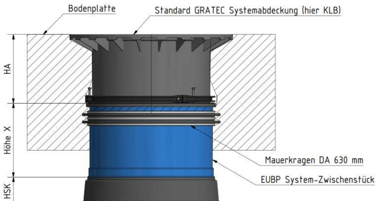
Eine weitaus flexiblere Lösung bietet das, monolithisch mit dem Schachtkörper verschweißte EUPH System-Zwischenstück. Hierdurch können unsere höhenverstellbaren Standard-Abdeckungen mit Dom verwendet werden und dieses ohne weiteren Aufwand exakt auf die Oberkante der Bodenplatte einjustiert und fixiert werden. Unterhalb des Mauerkragens sind keine Dichtstellen vorhanden, so dass drückendes Wasser von Unten nicht in den Schacht eindringen kann.
