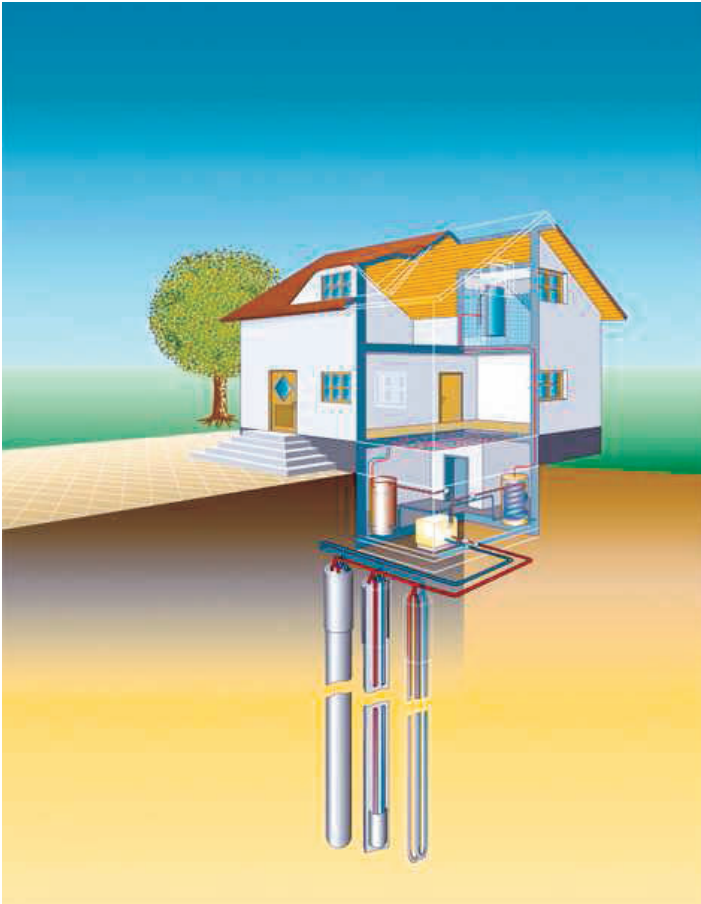
Abbildung 2: Systemskizze einer Erdwärmesonde [22]
