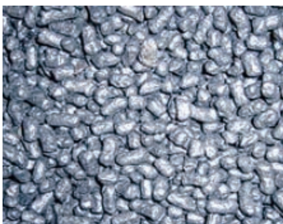
Abbildung 13: Tonpellets zur Verfüllung des Ringraumes [30]
