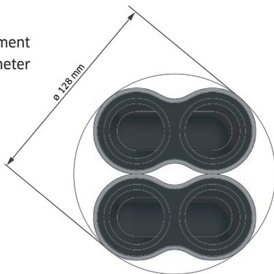
Sondenfuss versetzt montiert
