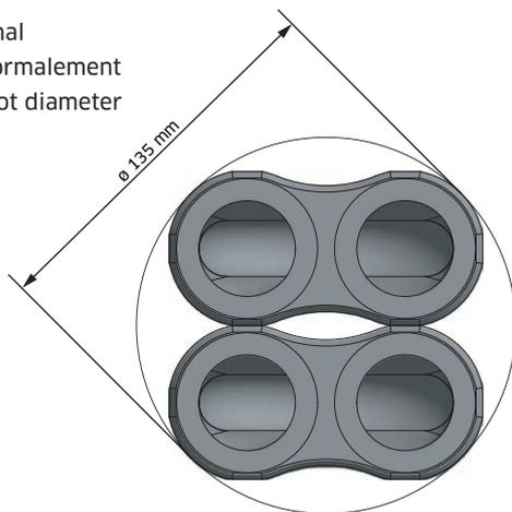
Sondenfuss versetzt montiert
