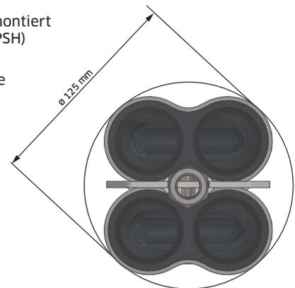
Sondenfuss versetzt montiert
