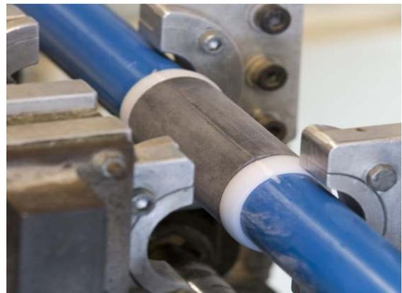
Die Verarbeitung, Wandstärke und Materialgüte der Injektionsrohre ermöglichen Injektionsdrücke von 60 bis 120 bar und bieten somit eine seit vielen Jahren bewährte, zuverlässige und preis- günstige Lösung für höchste Anforderungen und Beanspruchungen.
