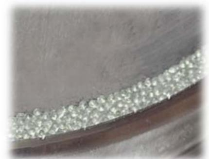
MP-System Glasfüllung vor dem Anschweißen des Filter-Verschlussrings
